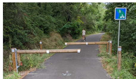
Dans le cas d'une chicane, il faut privilégier un espacement de 3 à 5 m entre les obstacles.
