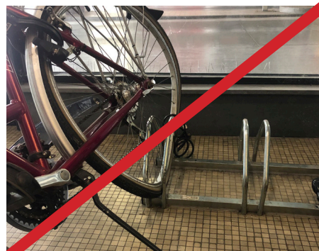
Arceaux à privilégier plutôt que les pincés-roues (ci-dessous)
