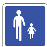
Entrée aire piétonne
