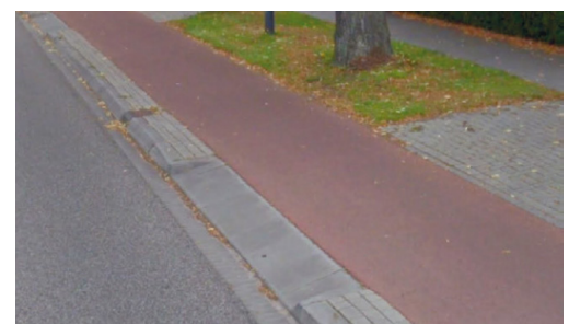
La piste cyclable ne s'abaisse pas au niveau de chaque accès privatif. Source : « Guide des aménagements cyclables », Paris en Selle, 2019
