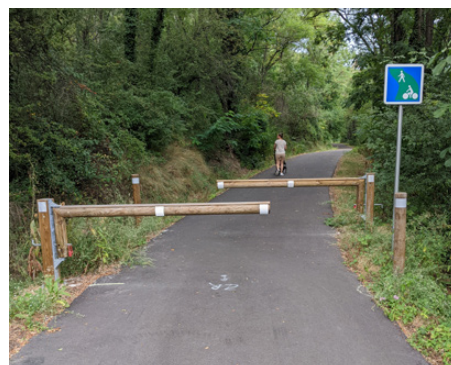
Dans le cas d'une chicane, il faut privilégier un espacement de 3 à 5 m entre les obstacles.
