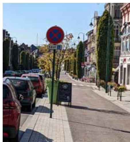
Piste cyclable bidirectionnelle séparée de la chaussée par une bande fonctionnelle (stationnement et mobilier urbain).
