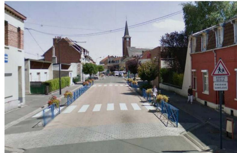
Exemple de délimitation des abords d'école : barrières anti-stationnement, plateau surélevé traversant avec 2 passages piétons, signalisation verticale (A13a et « sortie d'école » et « passage surélevé ») à proximité de l'école Felix Cadras à Avion.
